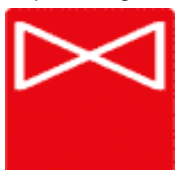
Valvola di intercettazione metano
